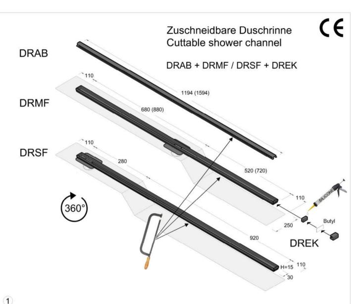
Schneiden Sie den 360° drehbaren Duschrinnen-Körper DRMF oder DRSF einseitig 2 mm kürzer als die gewünschte Länge der Duschrinne und die Duschrinnen-Abdeckung DRAB 15 mm kürzer als die gewünschte Länge der Duschrinne.
