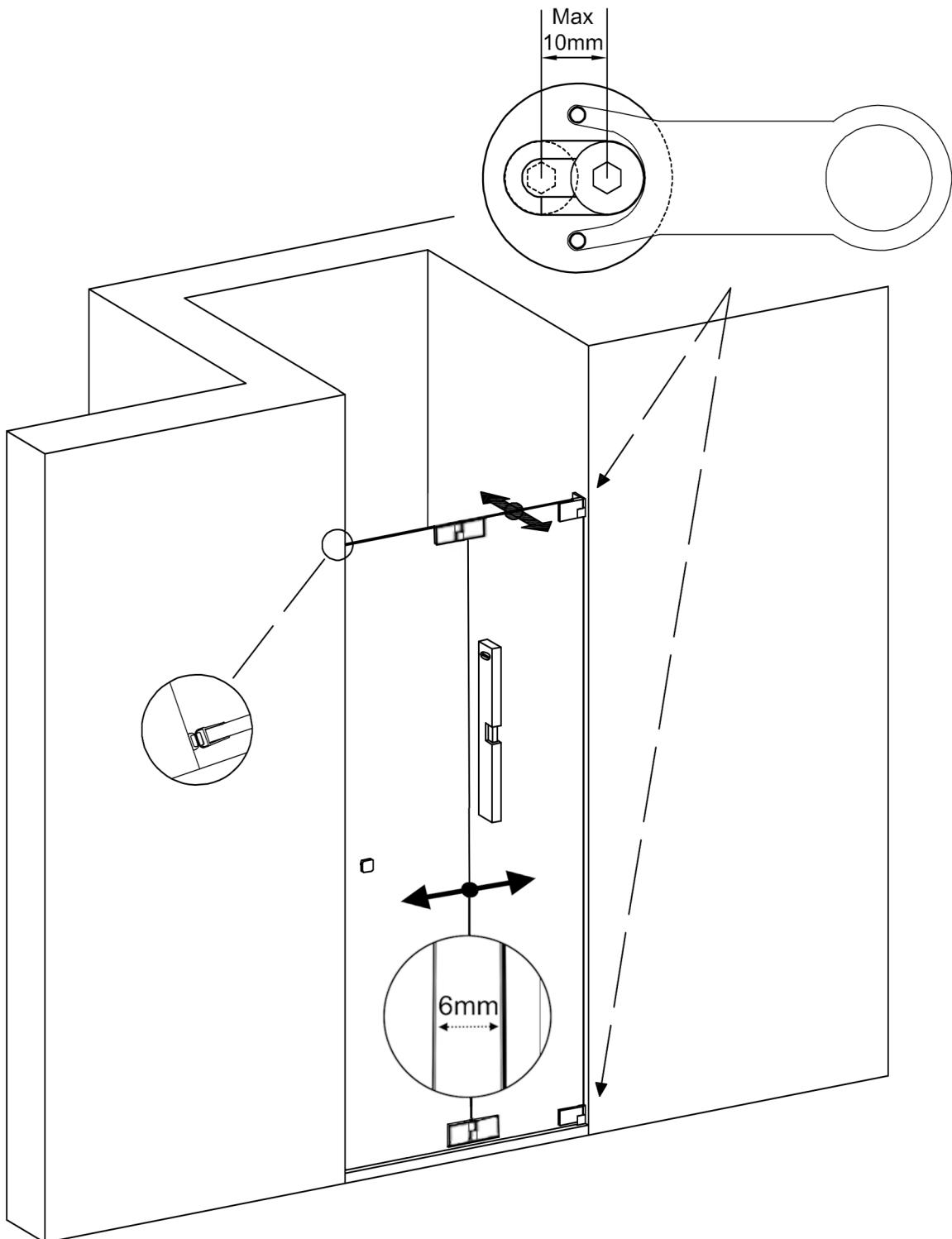
Richten Sie die Glas-Türe senkrecht aus und fixieren Sie die Inbus-Schrauben in den Langlöchern der Glasbefestigungen. Mit dem Montage-Schlüssel können die Glasbefestigungen dabei waagerecht gehalten werden. Schieben Sie dann das Tür-Kompensationsprofil (G7 / G7H) auf dem Glas an die Wand, so dass die Fuge zwischen Wand und Türe mit dem Balg leicht an der Wand anliegend gleichmäßig geschlossen wird.
