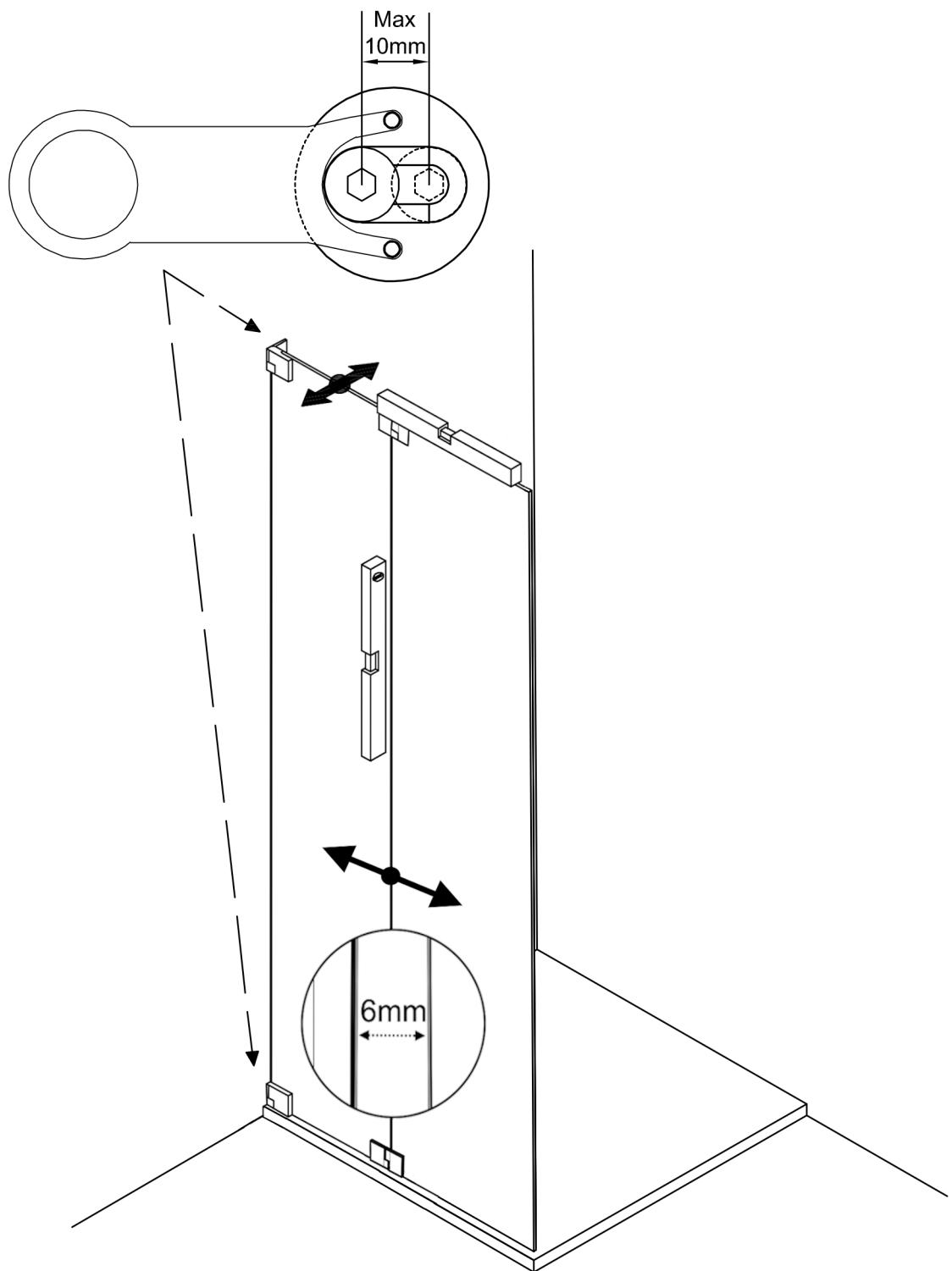
Richten Sie die Glas-Teile senkrecht aus und fixieren Sie die Inbus-Schrauben in den Langlöchern der Glasbefestigungen. Mit dem Montage-Schlüssel können die Glasbefestigungen dabei waagerecht gehalten werden. Schieben Sie dann das Tür-Kompensationsprofil (G7 / G7H) auf der Glas-Türe an die Wand, so dass die Fuge zwischen Wand und Türe mit dem Balg leicht an der Wand anliegend gleichmäßig geschlossen wird.
